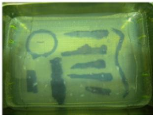
鉄製品の樹脂強化含浸処理
