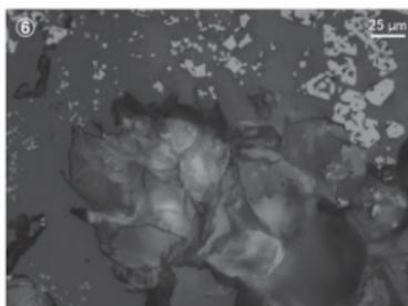
Photo.10 羽口の顯微鏡組織
