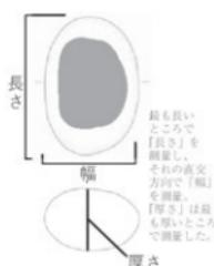
長も長いところで「長さ」を測量し、それの直交方向の「幅」を測量した。
