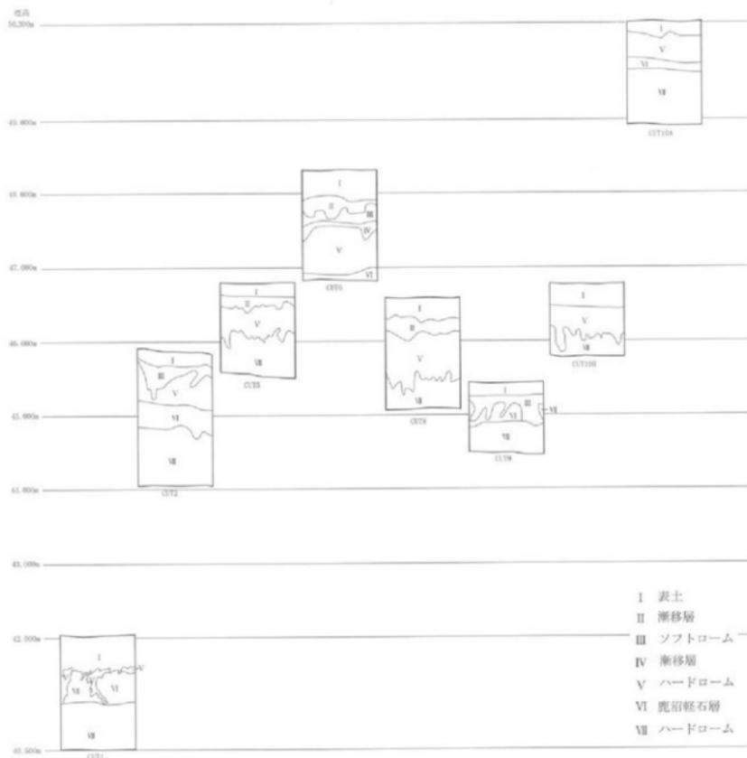
第2図 標準堆積土層柱状図 (S=1/60)
