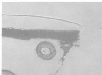
図377 後輪の漆塗膜断面  $\times 150$
