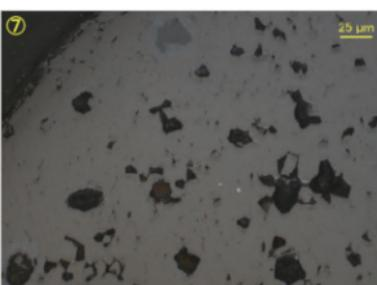
Photo.1 錫冶滓・粒状滓の顕微鏡組織
