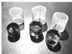
写真4 樹脂で包埋した試料
