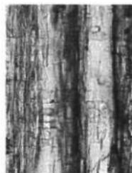
写真11 アカガシ亜属 柱目  $\times 100$
