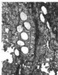
写真10 アカガシ亜属 木口  $\times 50$
