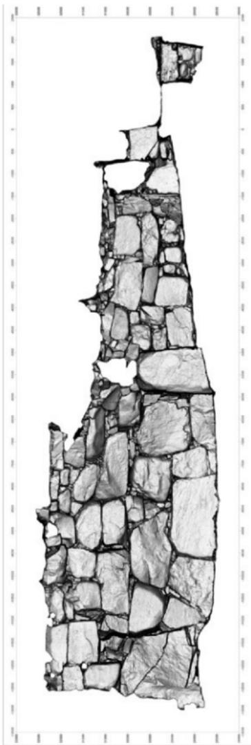
図版29-2 左側壁 立面図（三次元地上レーザー計測画像）
