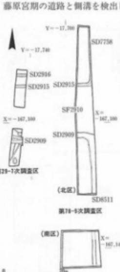
藤原宮期の道路と側溝を検出し、一部掘り下げたところでは弥生時代の土坑・小穴を多数検出した。ここでは藤原宮期の造構についてのみ言及・図示する。北区にある東西溝SD2915・2909がそれぞれ六条大路の北と南の側溝で、南北溝SD7758（北区）とSD8511（北・南区）が西一坊大路の西側溝にあたる。SD2915は幅0.9m、深さ0.3m、SD2909は幅1.0m、深さ0.2mで、この間が六条大路（SF2910）となる。大路の幅は南北側溝の心々間で16mとなる。SD7758は西脇のみの検出で幅は未確認、深さは0.3m。SD8511は幅1.2-1.5m、深さ0.2mである。六条大路の側溝とは、ともにL字形に接続する。南区で期待された右京七条二坊の宅地に関わる造構は確認できなかった。
