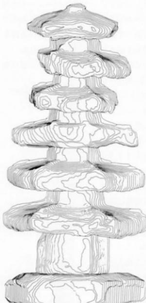
塔の森の石塔立面図(等高線間隔 2 cm出力図)
