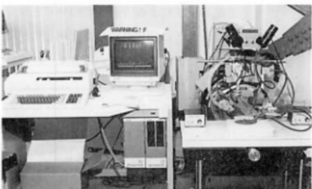
全試料型X線回折装置
