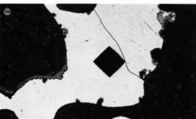
Photo.13 炉内津(含鉄)の顕微鏡組織
