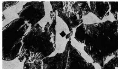
Photo.11 鉄塊系遺物の金属学的調査
