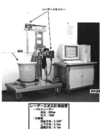
第177図 レーザー三次元計測装置の構成と仕様
