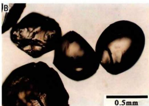
図15. 球形度の高い石英の例の実体顕微鏡写真。
