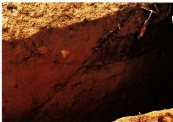
写真4 地すべりによる破壊面A（地すべり面）トレンチI2の壁面より
