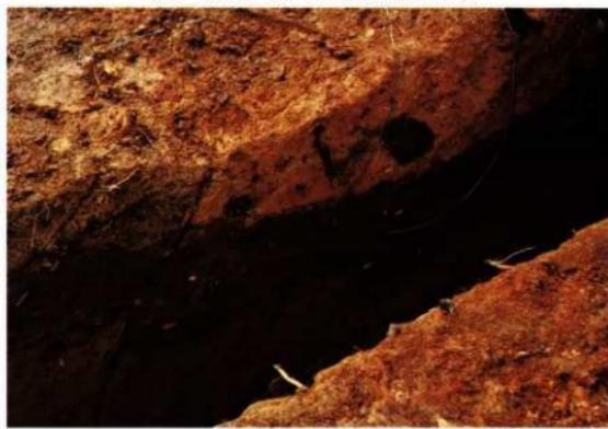
写真5 地すべりによる破壊面B（地すべり面）トレンチI2の壁面より
