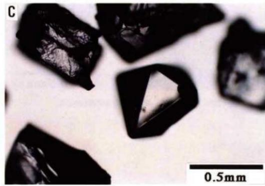
図16. 球形度の低い石英の例の実体顕微鏡写真。
