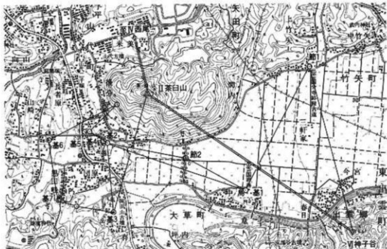
第9図 基準点測量網図 1:25000
