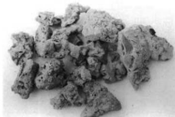
炉床の谷奥側端部を閉塞していた鉄滓片（流出滓）
