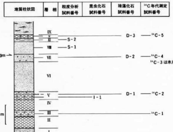
第24図 山中遺跡地質柱状図および分析試料採取層準
