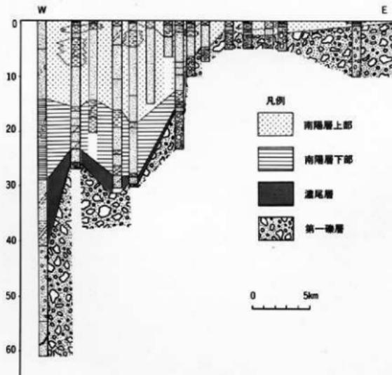
第4図 滝尾平野地下地質模式断面図（東-西方向）
