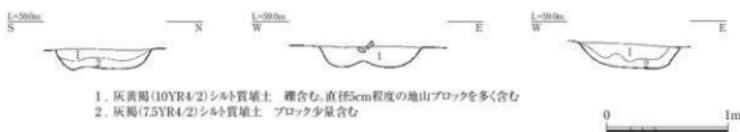
図 34 SD194 土層断面図 (S: 1/40)
