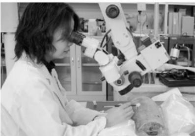
図54 顕微鏡下でのクリーニング作業風景
