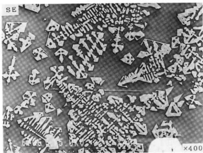
図版16 NO.10 SK1183鉄滓の特性X線像 (SE)
