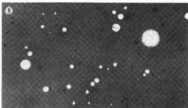
Photo. 22 鉄滓・銀精錬滓の顕微鏡組織(縮小0.8)
