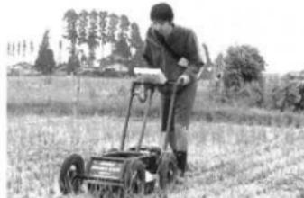
図4 地中レーダ探査風景
