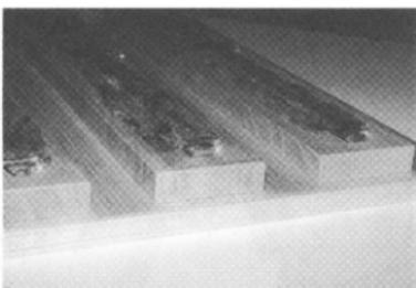
写真97 台座板側面の接着状況
