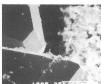
写真53 断面に生じた結晶
