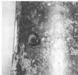
写真62 クレーター状に腐食した表面 (2号錆)
