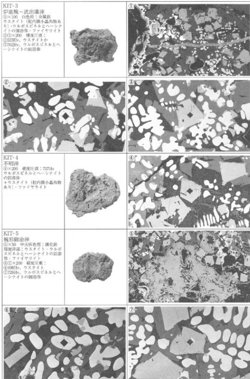
photo. 2 炉底塊～流出溝滓・不明滓・椀形鍛冶滓の顕微鏡組織
