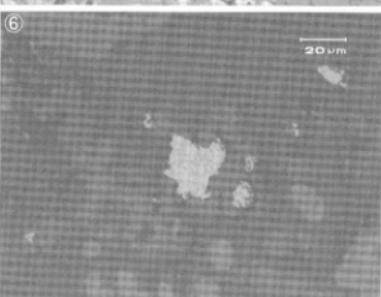
Photo.4 楢形鋳治滓の顕微鏡組織
