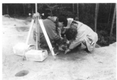
熱残留磁気測定の作業風景
