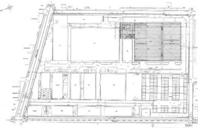
第1図 工場施設増築計画図 (S= 1/200) 條かけが増築箇所
