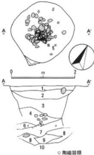
S E67から検出した木棒の構築上の特徴を述べると、S E61から検出した木棒構築と類似している点が多い。側板は、平均3枚の縦板によるが中央の板は狭小で両端の板が主力である。南・北の横棟は上、東西の横棟は下の位置で各面の側板端の柄を切ってはめこむ方法で組み立てられ、横棟は各面2段が残っていたため45cm（約1尺5寸）ぐらいの幅で上層に組み立てられていたと考えることができる。側板の幅（木棒の一辺）は80~85cmであり、S E61木棒よりは若干狭い。また、側板固定のために外側に小さな板などをはさみ込む部分もあり（東側など）側板の固定には特に注意を要したようである。
