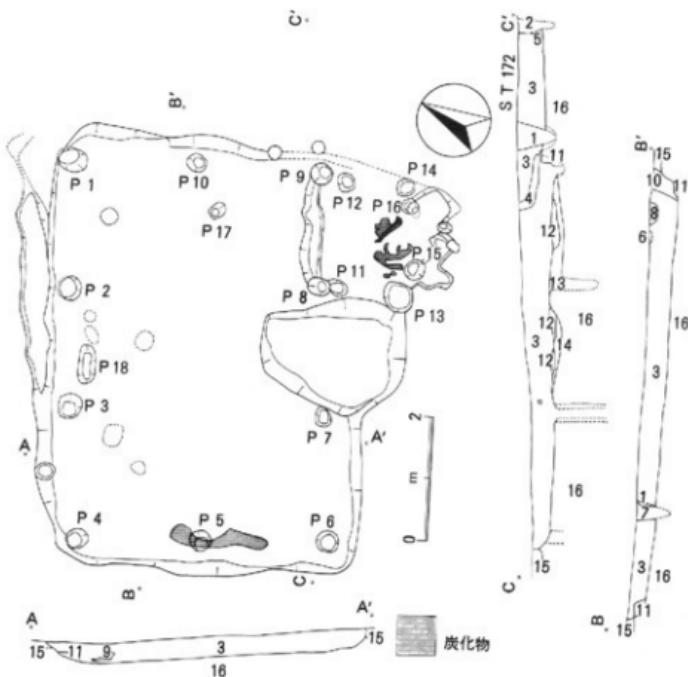
S T 184 B—Pit 15～Pit 28までの柱穴配置で、規模 4 間× 2 間を呈し、東壁南側に E—20°—N の方向の張り出しを有するもの。
