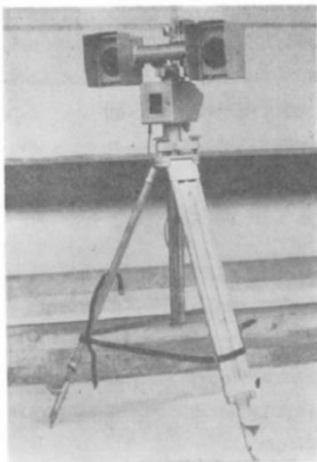
第2図-① 写真測量用カメラ SMK40
