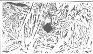
Photo. 3 鉄鉗の顕微鏡組織(鍛伸方向)
