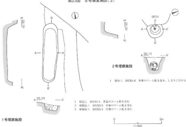
第24図 8号墳1・2号埋葬施設実測図
