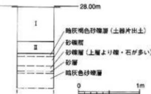
図37 99208-2トレンチ土層柱状図 (縮尺 1/40)
