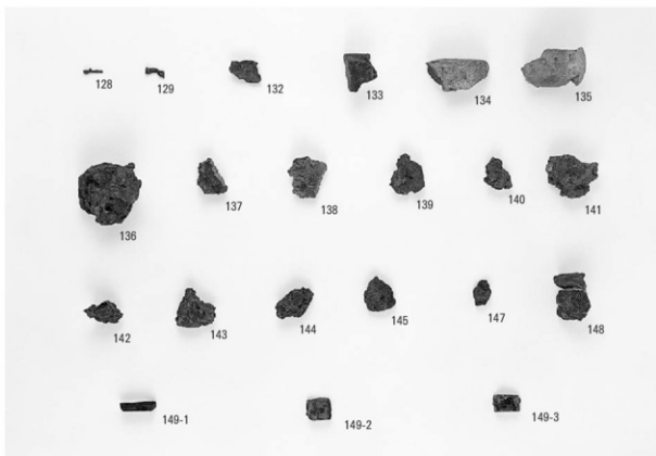
製鉄関連遺物 (6) 単位流動滓(128・129)・羽口(132・148)・被熱石(133~135)・再結合滓(136)・炉壁(137~141)・炉内滓(142~145)・流動滓(147)・木炭(149)
