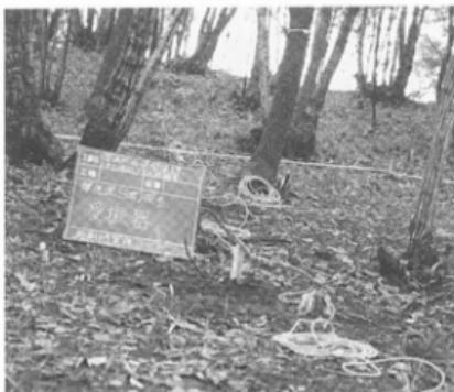
弾性波探査受振器設置の様子
