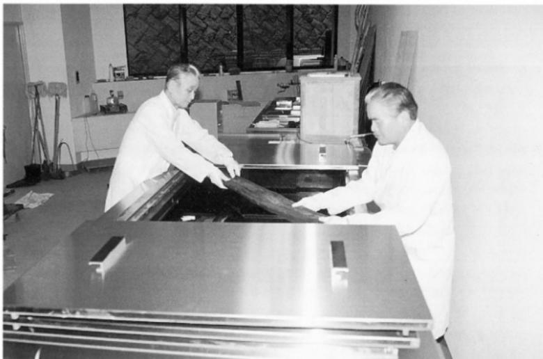
写真1 処理済木製品の取り出し作業
