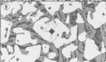
Photo.8 椀形鍛冶滓の顕微鏡組織
