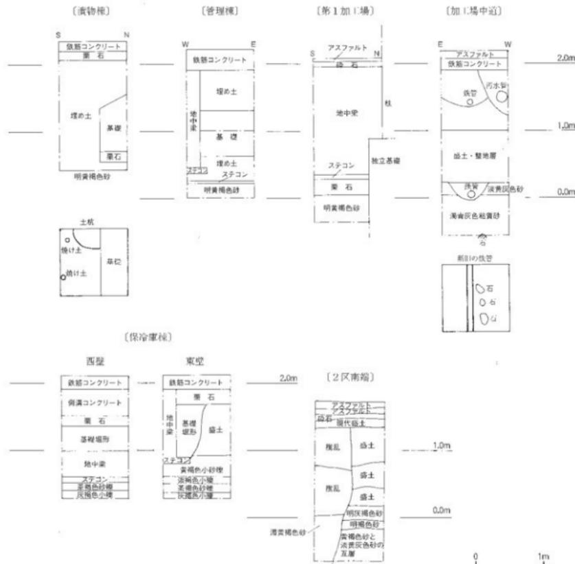
fig.81 試掘坑土層断面模式図（2）
