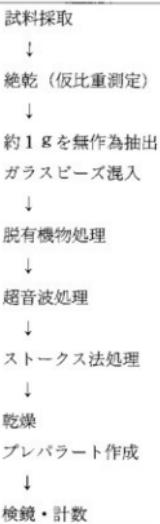
ールに付着した汚れを取り除いたりガラスピースを均等に分散させるために、脱有機物処理、超音波処理、ストークス法処理を行なう。
