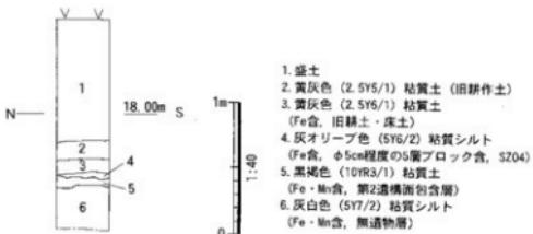
fig. 4 基本土層柱状図
