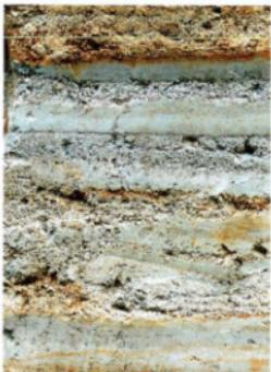
写真8 中下部砂泥互層の洪水氾濫堆積物の逆級化構造。下位から上位へ粘土層から砂層へ漸移するユニットが認められる。写真の横幅は約60cm。
