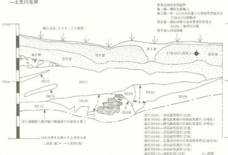
5.同定土壌試料TUE-0101採取地点の地層断面図—土生川左岸側方浸食崖
