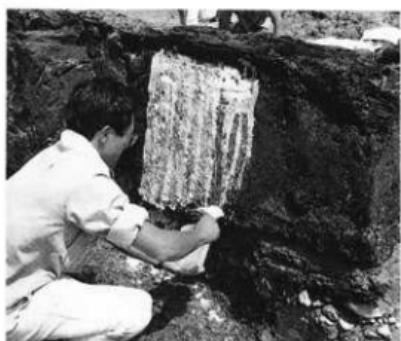
fig. III-23. 転写用樹脂塗布作業
