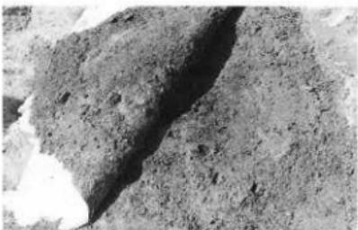
fig. III-2. 先の樹脂が半ば硬化してからガーゼを貼り、再度同じ要領で樹脂を塗り、完全に硬化してから剥がし取る。
