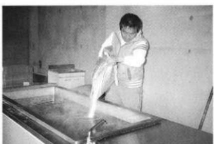
fig. III-36. 低濃度時は、粉末のPEG4000をそのまま投入し、濃度を上げる
