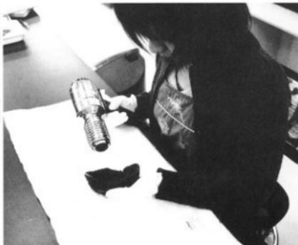
fig.183 含浸後クリーニング作業
