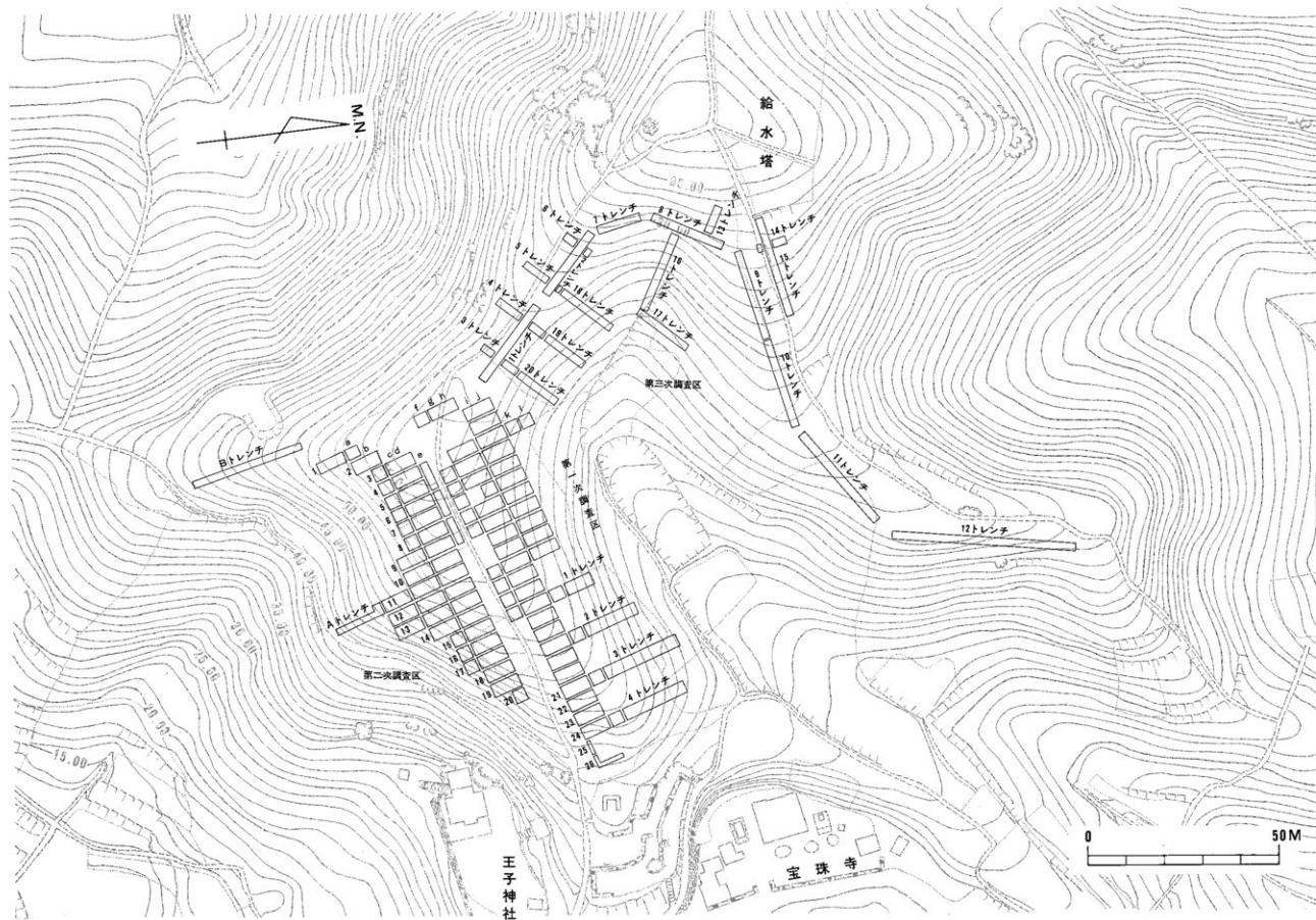
第2図 地形測量図及びトレシチ配置図
