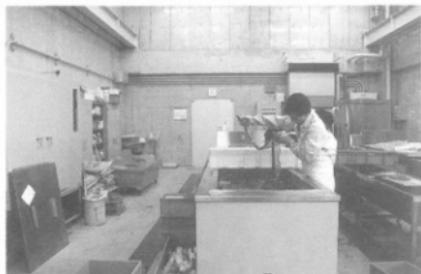
fig. 227 PEG含浸の完了した木製品を取り上げる
