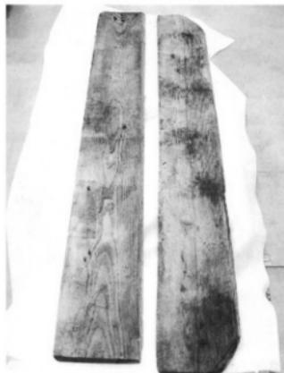
fig.259 PEG含浸完了後
