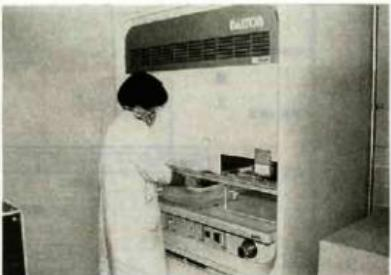
第2図 トリクロールエチレンによる木製品表面処理
