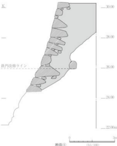
図89 平成19年度B1面石垣断面図
