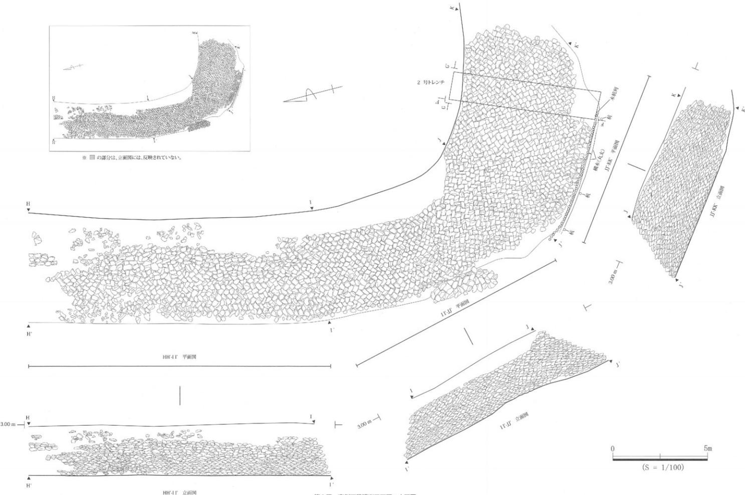
第9図 東側石積護岸平面図・立面図
